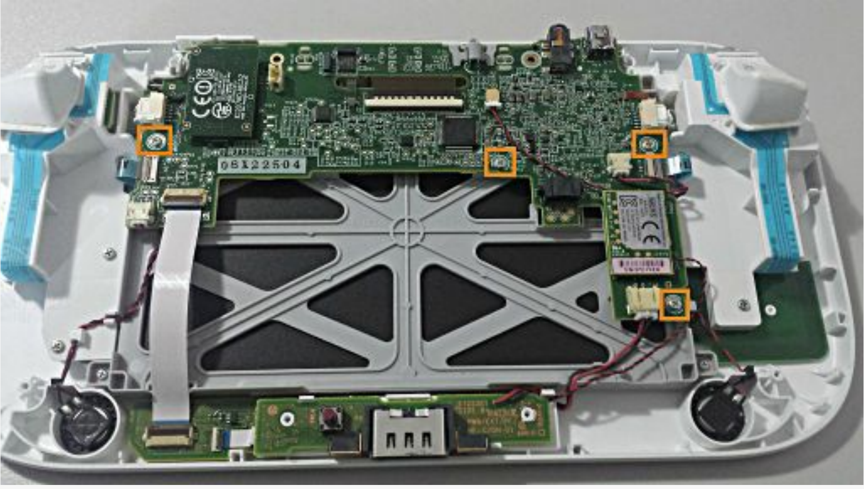
l) Scollegare i connettori jack degli altoparlanti, del modulo di ricarica, del tasto home, della basetta comandi, joypad, trigger e grilletti posteriori.
